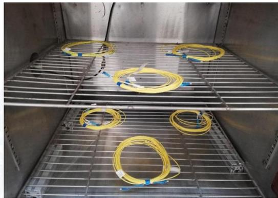
Figura 4. Muestras bajo ensayo durante la prueba de ciclado térmico
