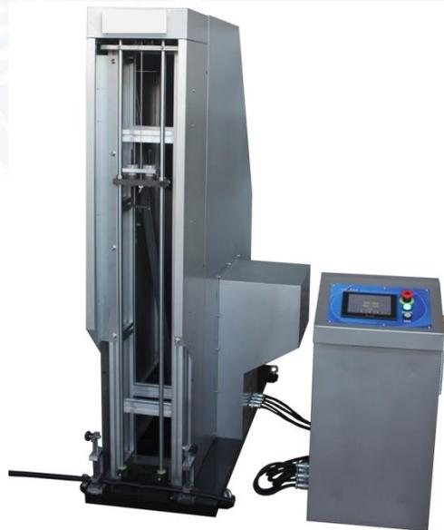
Figura 8. Máquina de impacto, norma internacional "IEC 60794-1-2 optical fiber cables – basic optical cable test procedures. Method E4 – Impact". Laboratorio de Pruebas Mecánicas. FIBERLAB S. DE R.L. DE C.V.
