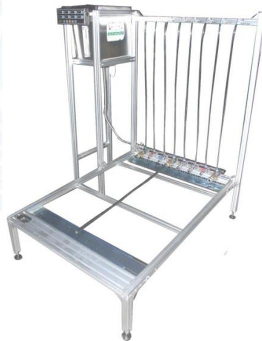
Figura 16. Máquina de penetración de agua, norma internacional "IEC 60794-1-2 optical fiber cables – basic optical cable test procedures. Method FB5 – water penetration".
